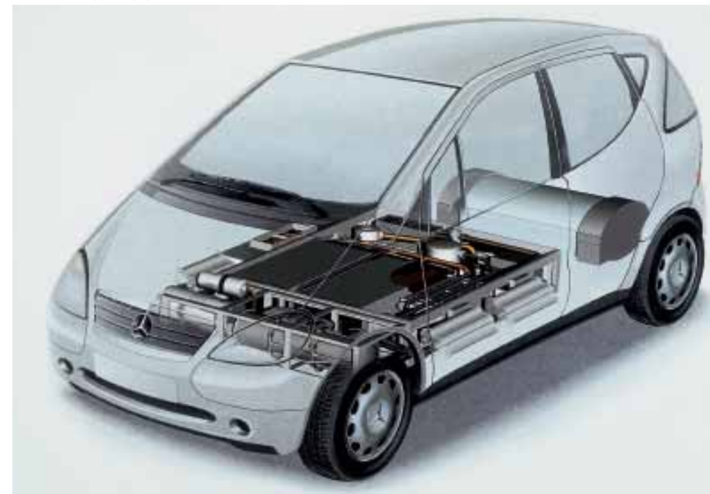
De laatste jaren zijn de automobiel- en de gasindustrie er goed in geslaagd om de waterstoftechnologie compacter te maken. Deze Mercedes laat dat duidelijk zien.
