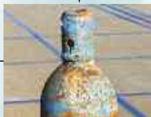
Afkeur door bijv. corrosie, laspitten of defecte kraan
