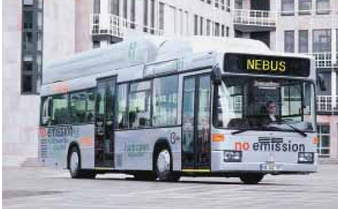
Prototype van de stadsbus op waterstof, zoals die gaat rijden in negen Europese steden.
